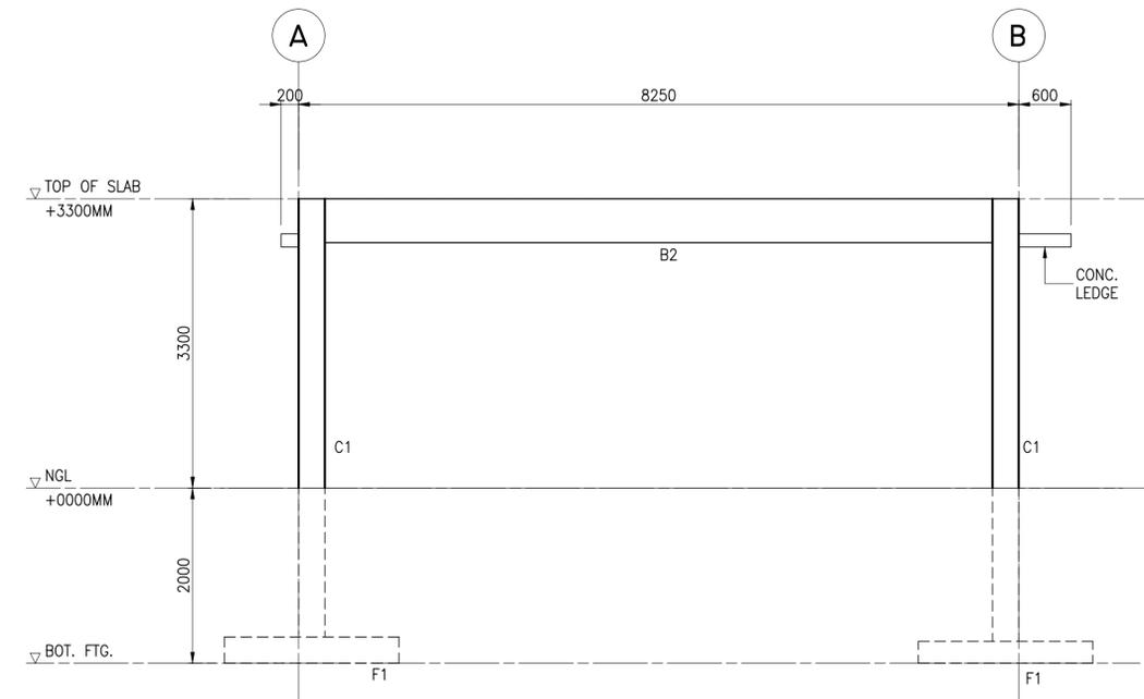
FRAME ELEVATION ALONG GRID 1
